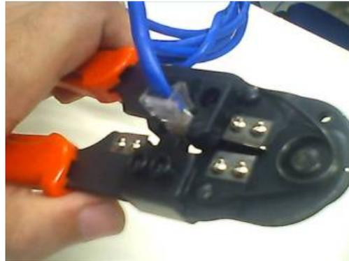
6. Sacamos el cable de la pinza y revisamos que haya quedado bien, que la cubierta del cable haya quedado dentro del conector y que todas las puntas del cable estén hasta el tope de este.
