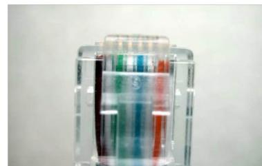
5. Después de asegurarnos que todos los cables están en la posición correcta, que llegan hasta el final del conector y que la cubierta está bien introducida; metemos el cable al conector de la pinza ponchadora, fijando bien el cable con el conector, y apretamos fuertemente el mango de las pinzas hasta que las cuchillas del conector RJ45 presionen al cable UTP.
